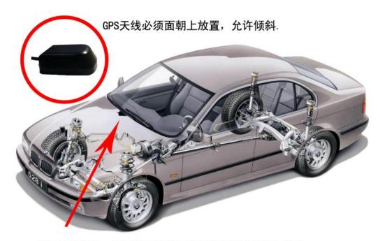
GPS天线位置,建议放置在档风玻璃正下方塑料壳底下。
